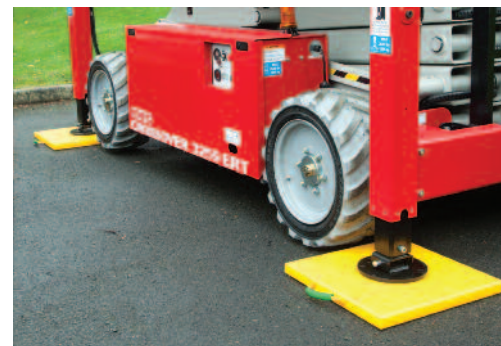
Hi-Viz plattor används på en terräng sax lift
